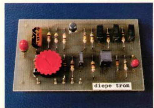
Afb. 13. Complete montage van de print waarop de "diepe trom" is gemonteerd.
