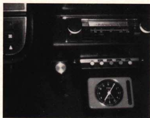
Afb. 13 Enkele klokken. a) Kwartsklok van Staiger ingebouwd als autoklok; hiervan bestaat ook een zwarte uitvoering. b) Bijzonder geruisarm; de Kundo-wekker met stappenmotor. c) Twee gunstig geprijsde modellen van Kienzle. Al deze klokken werken met HF-kristallen op 4,19 MHz.
