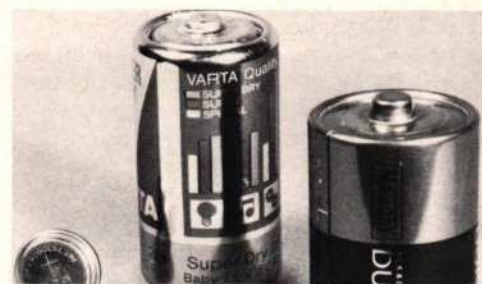
Afb. 12 Typische stroombronnen voor kwartsklokken (staafbatterijen) en horloges (knoopcel). Geen problemen bij grote klokken: een staafbatterij heeft een capaciteit van 2500 mAh en maakt bij een opgenomen stroom van 150 \mu A één jaar continu bedrijf mogelijk, met een duurdere alkali-mangaan batterij zelfs tot 3 jaar. Knoopcellen voor horloges hebben doorgaans een capaciteit van 150 mAh wat bij een opgenomen stroom tussen 8 en 15 \mu A eveneens voldoende is voor een jaar of meer. Het grote aantal verschillende typen, d.w.z. het ontbreken van enige normalisatie, bemoeilijkt de vervanging ervan.
