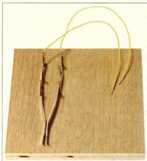
Afb. 3.5. Het plankje met de stripjes. Let op de zoutkorrel
