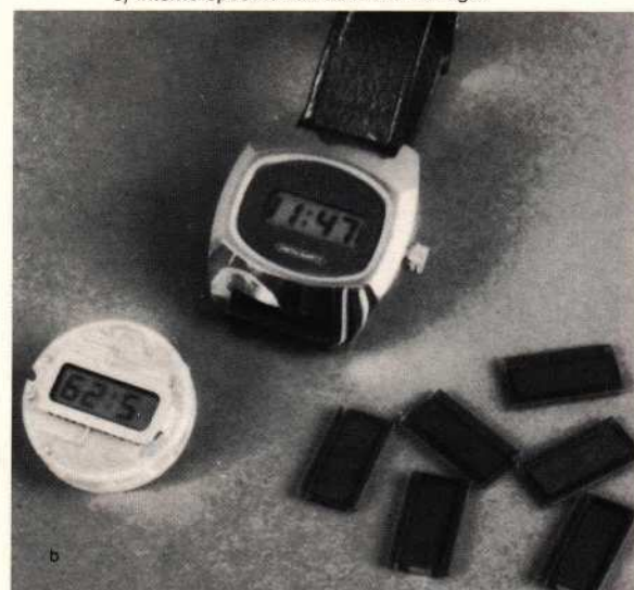
b) LCD-systeem als onderdeel in een horloge ingebouwd en in een compleet horloge (Siemens AG). c) Interne opbouw van een LCD-horloge.
